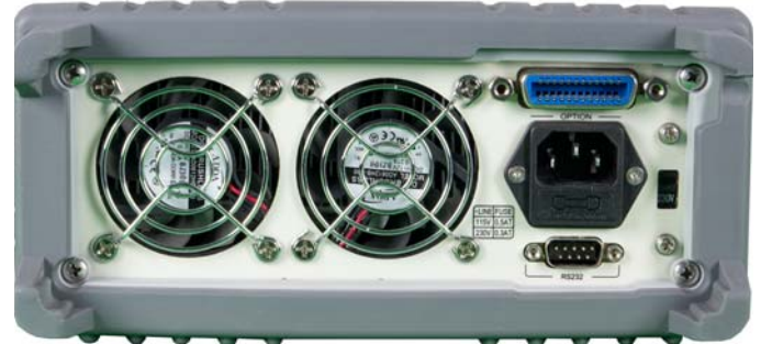
Geräterückseite mit Gummischutz und optionalem GPIB Interface
